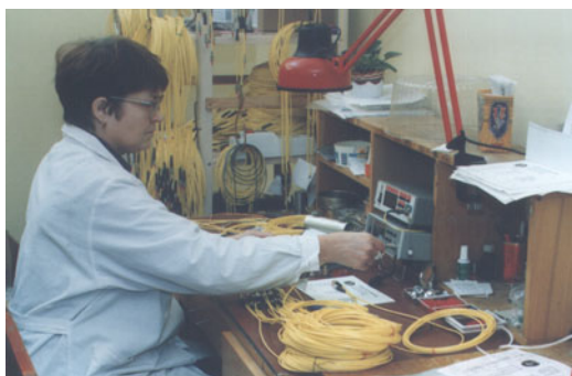
Рис.36. Рабочий эталон второго разряда (б) и его использование (а) для тестирования соединительных шнуров.
