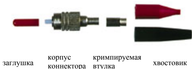
Рис.76. Конструкция коннектора FC.
