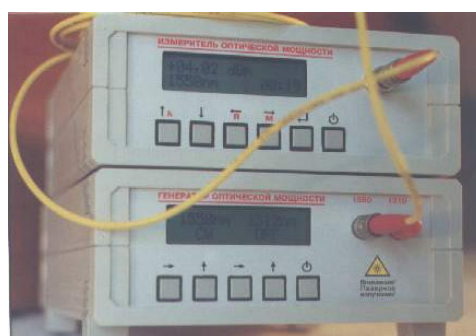
Рис.36. Рабочий эталон второго разряда (б) и его использование (а) для тестирования соединительных шнуров.
