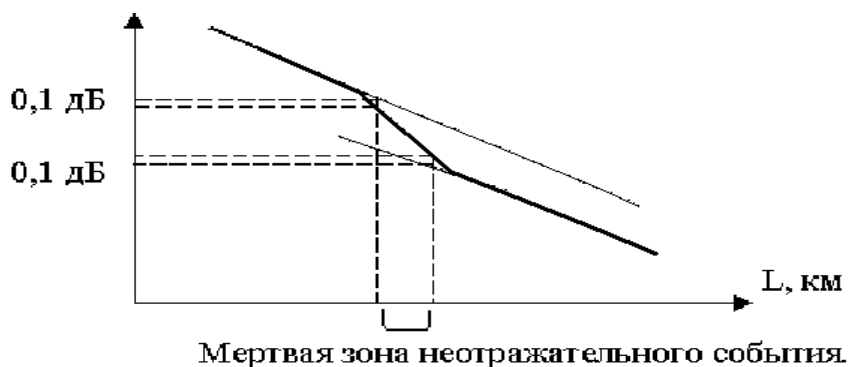
Рис.49. Определение мертвой зоны для неотражательного события.
