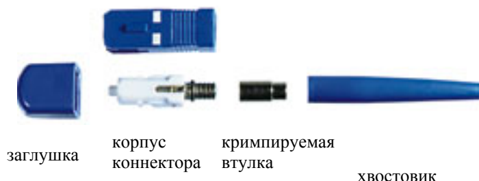
Рис.77. Конструкция коннектора SC.
