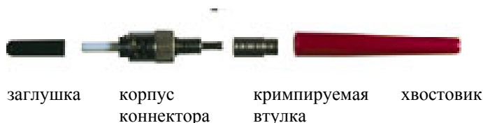
Рис.75. Конструкция коннектора ST.
